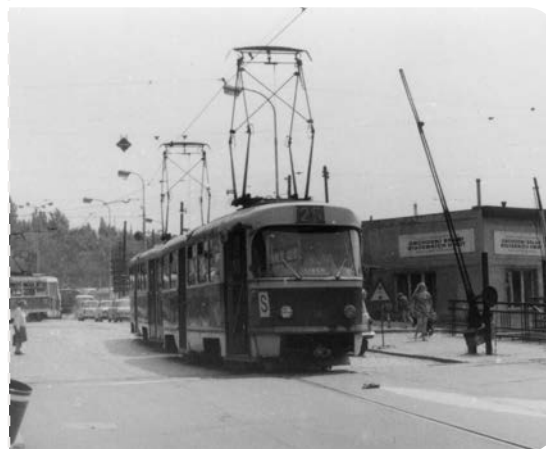
Během prázdninové výluky v roce 1973 při neprůjezdnosti Sokolovské ulice musely tramvaje manipulačně (a bez cestujících) přejíždět přes „skákačí kolejevé křížení“ na Palmovce. Preventivně byl ke křížení přistaven pohotovostní autojeřáb, aby urychleně nakolejil tramvaj, která by zdárně nezvládla překonat toto rizikové místo.
