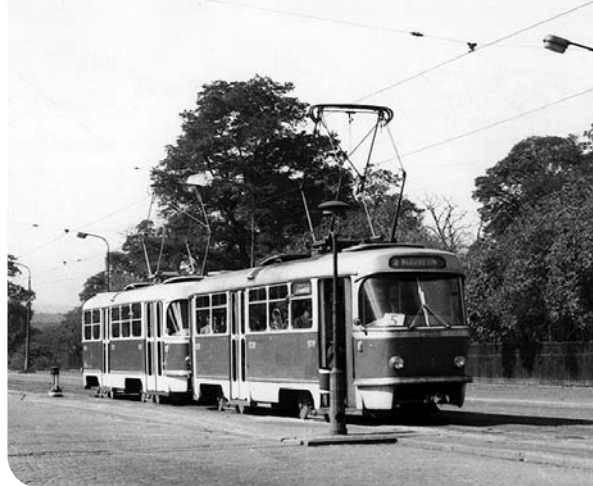
Fotograf zachytil v roce 1964 jednu z prvních souprav tramvají T3 u Invalidovny. Z hlediska komfortu i jízdních vlastností se jednalo o velký krok kupředu. Oproti soupravám dvounápravových tramvají ale násobně vzrostl i odběr elektrického proudu a obtíž s napájením proto přetrvávaly ještě řadu let.
