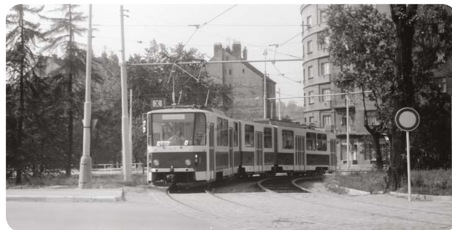
Při průjezdu výlukové linky č. 33 přes manipulační kolejový oblouk propojující Vysočany s Českomoravskou ulicí zachytil fotograf 20. července 1989 tehdy úplně novou tramvaj KT8D5 č. 9005. Číslo linky se standardně zobrazovalo na převíjecí roletě v „budníku“ na střeše. Na roletě ale nebyla všechna čísla linek, a tak bylo nutné použít plechovou tabulku a umístit ji za čelní sklo tramvaje.
